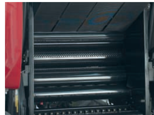
Les rouleaux en acier sont alvéolés pour faciliter la rotation de la balle et minimisent les risques d'enroulement de fourrage.
