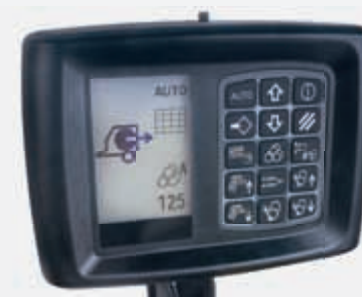
Nouvel écran noir et blanc avec rétro-éclairage approprié pour les travaux de nuit.
