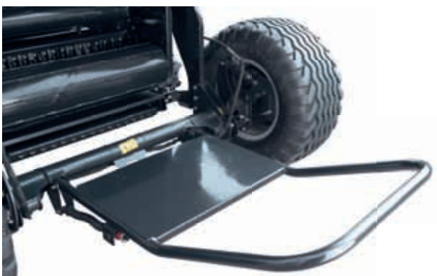
L'éjecteur de balles permet d'écarter la balle de la porte afin de pouvoir la refermer en toute sécurité.
