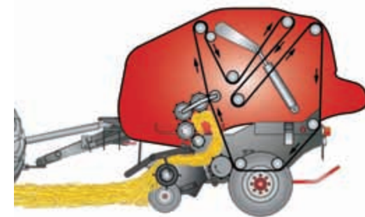
L'action combinée des courroies et des rouleaux assure une forme et une densité de balle optimales.
