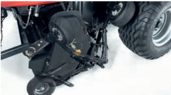
Un nouveau système de roues de jauges pivotantes qui peuvent être repliées pour le transport sans avoir besoin d'utiliser d'outils.
