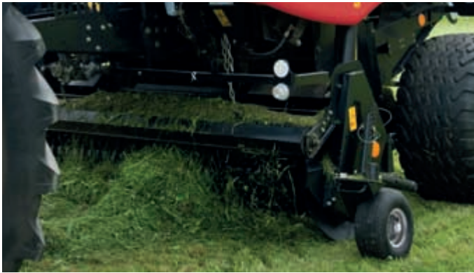
Un nouveau ramasseur composé d'un système à 5 rangées de dents pour un ramassage intégral, avec un débit important et régulier.
