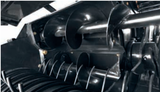
Une vis transversale d'alimentation est placée au-dessus des deux vis de centrage pour optimiser l'alimentation du fourrage.
