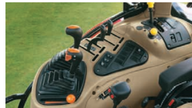
Pure functionaliteit voor Maxxum-tractoren. U kunt kiezen tussen een 2-traps Powershift-transmissie met 24x24 versnellingen en de...
