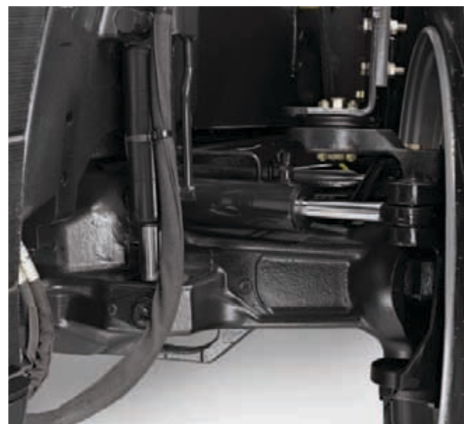
Volledige stabiliteit, een vlotte rit en vol vermogen naar de grond dankzij de voorasvering.
