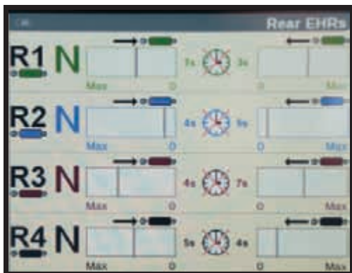
Bedien uw afstandsventielen via het AFS 700 Pro-scherm.
