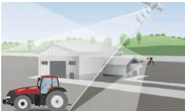
xFill overbrugt hiaten tot 20 minuten in RTK-signalen.
