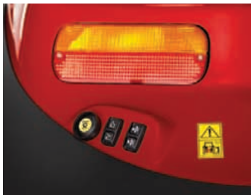
Gemakkelijke en veilige bediening met de externe controles.
