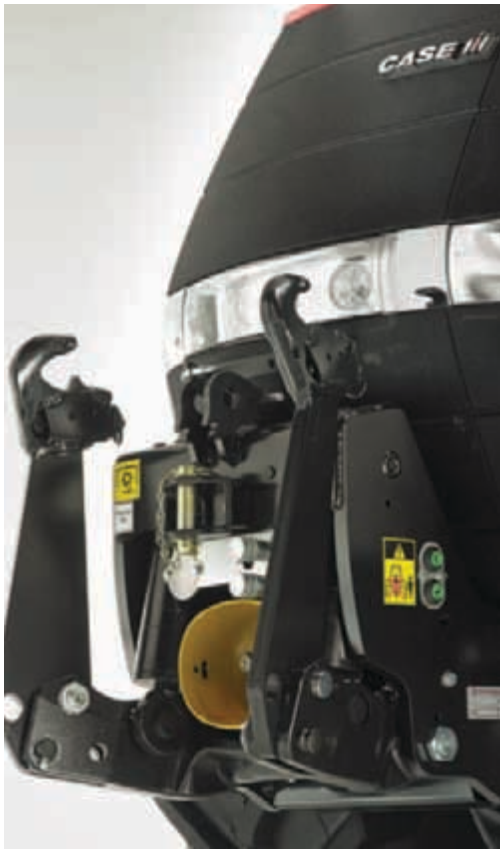
Naadloos geïntegreerde fronthef met een hefvermogen van 5.000 kg.
