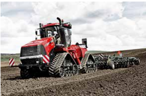
Le principe adopté pour le Magnum Rowtrac est le même que pour le Quadtrac avec quatre points de contact avec le sol.
