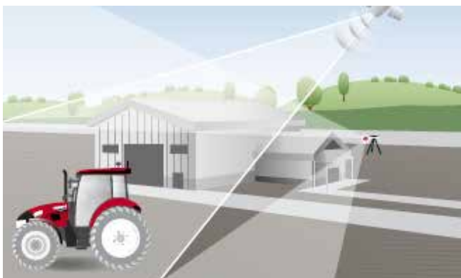
Le système xFill comble les lacunes du signal RTK jusqu'à 20 min.
