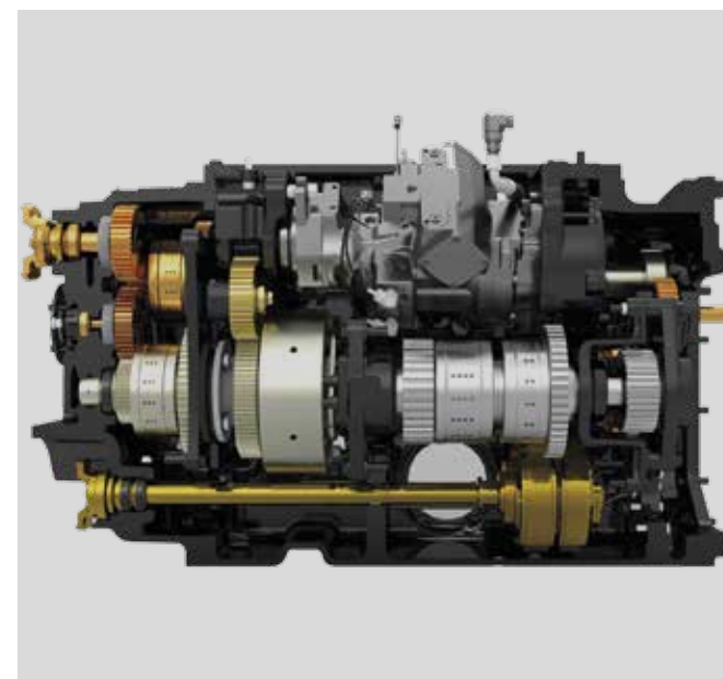
Transmission CVX – une conduite en continu de 0 à 40 km/h.
