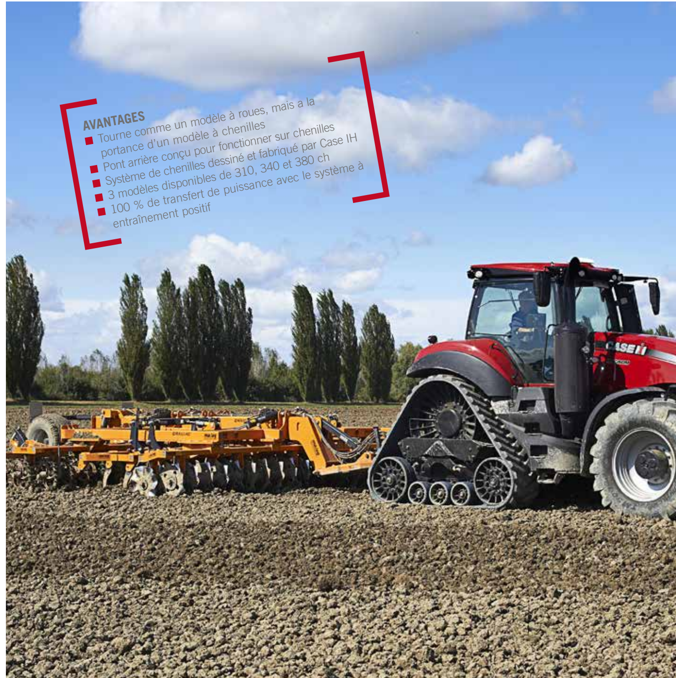
Le principe adopté pour le Magnum Rowtrac est le même que pour le Quadtrac avec quatre points de contact avec le sol.
