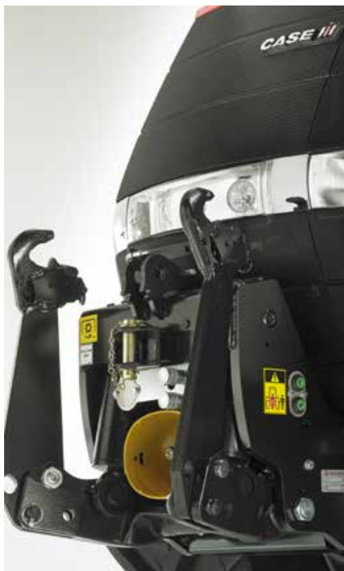
Un relevage avant parfaitement intégré avec une capacité maximale de 4 275 kg.
