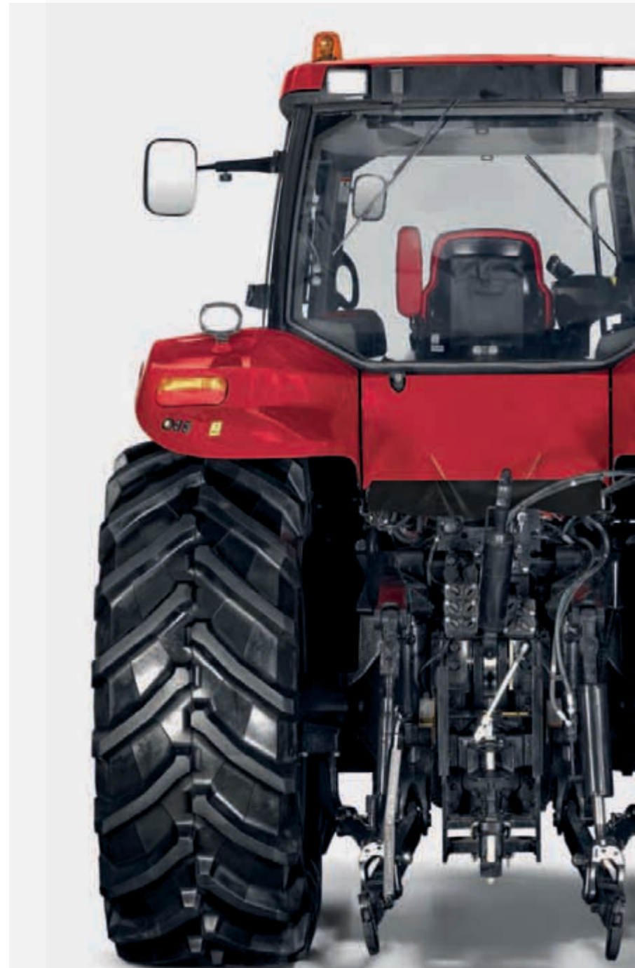
Geen bedieningsgrenzen dankzij 6 elektrohydraulische afstandsventielen achteraan
