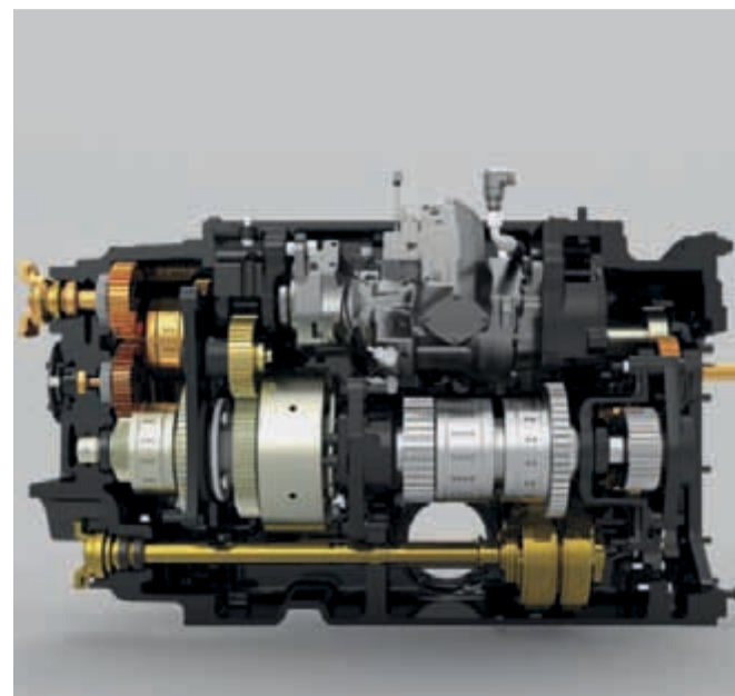
Transmission CVX - pour une conduite progressive de 0 à 50 km/h
