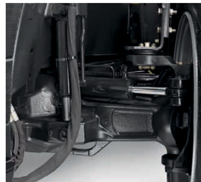
Stabilité parfaite, conduite en douceur et puissance transmise intégralement au sol grâce à la suspension avant
