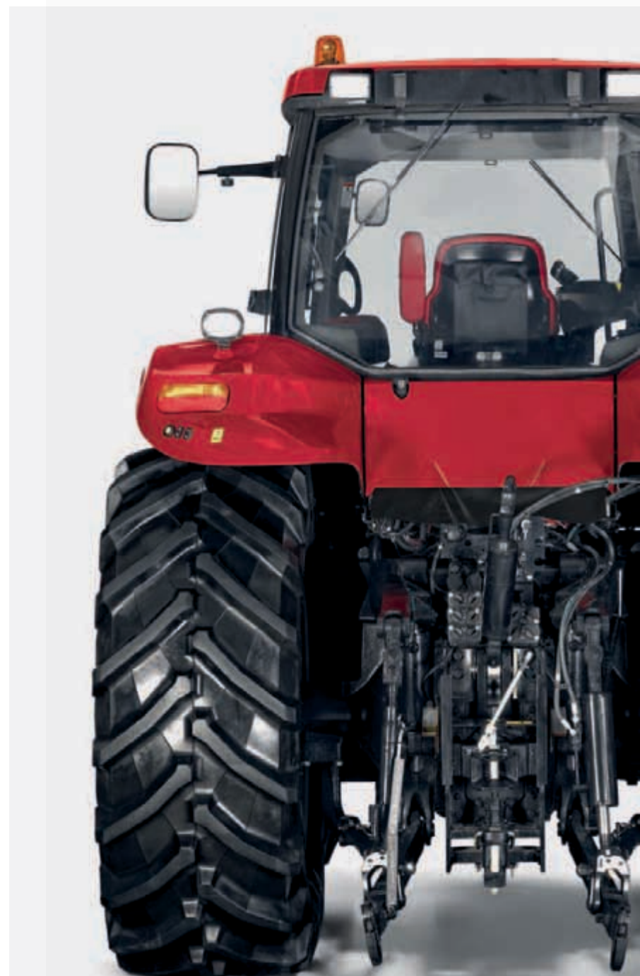
Aucune limite de commandes grâce aux 6 distributeurs arrière électrohydrauliques
