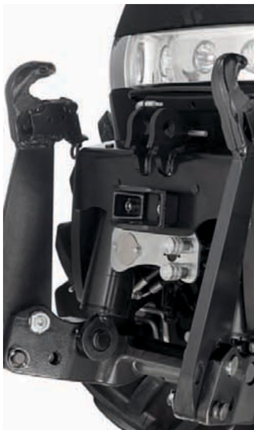
Relevage avant intégré, avec capacité de levage de 5 000 kg
